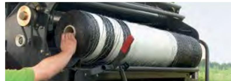
DEUTZ-FAHR Rundballennetz wird unter Verwendung der Bale+ Technologie produziert. Bale+ ist eine Kombination aus speziellen Rohstoffen und einem einzigartigen Fertigungsprozess.
