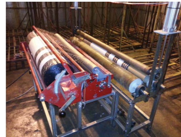
Nachbau des Welger Netzeinzugs- und Bindsystems unter Verwendung von Originalteilen. Der Apparat steht in einer Klimakammer um unterschiedlichste Temperatur und Luftfeuchtigkeiten zu simulieren.
