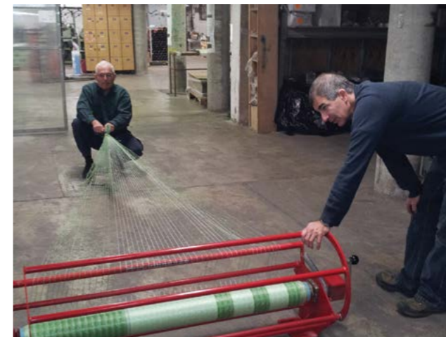
Mit diesem Gerät wird das Verhalten vom Netz zur Netzbremse getestet.
